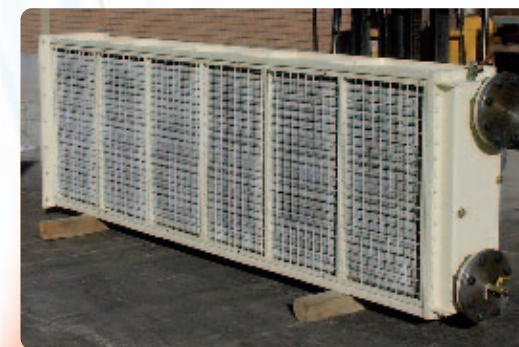
• مبدل های خنک کننده هوا - ژنراتور گازی (پروژه Ansaldo)
